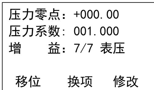
**压力通道：**通过输入压力修正参数，对传感器采集压力进行修正，如果是设置压力，则不用设置此项。
