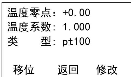
**温度通道：**通过输入修正参数和传感器类型，对传感器采集温度进行修正，如果是设置温度，则不用设置此项。温度零点：传感器采集过来的温度加上此温度为流量运算的温度。温度系数，对温度进行倍数修正的参数，如果不进行修正，则此处设置为1。类型为温度传感器类型，现可选择Pt100和pt1000。
